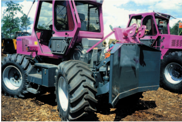
Tractor agrícola con escudo, adaptado para el desembosque.
