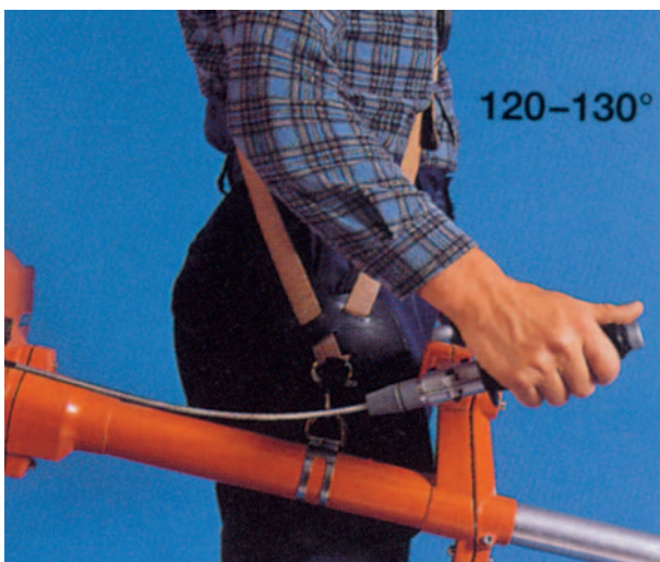
Si la máquina cuelga libremente con un ángulo de 120-130°, el ajuste es perfecto.
