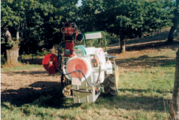
Equipo difusor de productos químicos acoplado a tractor.
